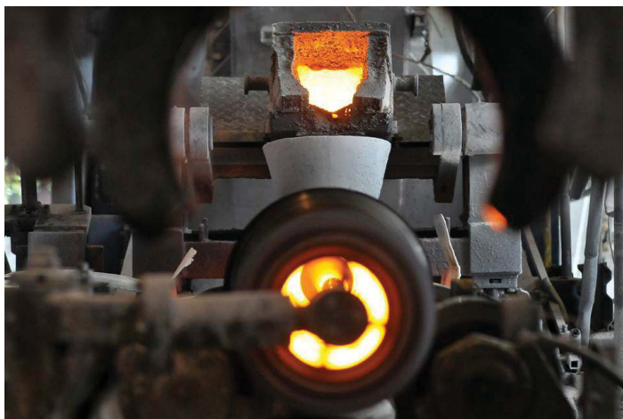
Slika 11. Centrifugalno lijevanje cijevi od sivog lijeva u ljevaonici Ferro-Preis d.o.o. / Figure 11. Centrifugal casting of grey cast iron pipes at the Ferro-Preis d.o.o. foundry
